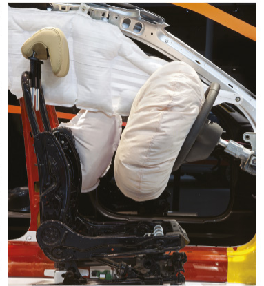
Рисунок 1-7. Боковые подушки безопасности и воздушные занавески представляют угрозу для спасателей, если они не были активированы ранее при столкновении. Примечание: см. "Access: First on Scene — Rapid Vehicle Entry Provider Manual" от PLS для подробной информации о безопасном обращении с несработавшими подушками безопасности (источ. Shutterstock).
